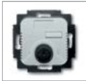
Механизм терморегулятора 1) С дистанционным датчиком и термической обратной связью. для полов с электроподогревом, с контрольной лампой и переключателем для экономичного режима (снижение температуры 4К), Переключающий контакт размыкается по достижении заданной температуры. с крепежными распорками, длина проводки датчика: 4 м, Датчик=NTC, 10 кОм при 25 °С. Диапазон регулировки: +10 - +50 °С. соединительный кабель: 1мм 2 до 2,5 мм 2 , с отдельным входом для временно-зависимого переключения в экономичный режим, Номинальное напряжение: 230 В~ Номинальный ток: 16 А, при cos φ 1 EN 60730-2-9, EN 60669-2-1
